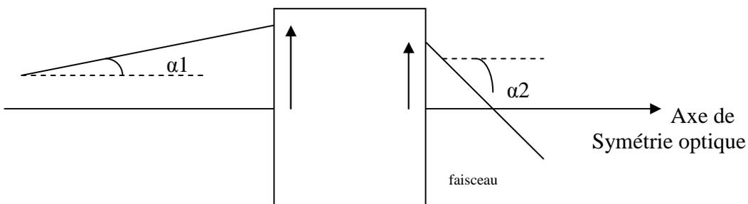
Les paramètres du faisceau à la sortie du système  $\alpha_2$  et  $r_2$  sont reliés à  $\alpha_1$  et  $r_1$  par des équations qui prennent la forme matricielle suivante :
