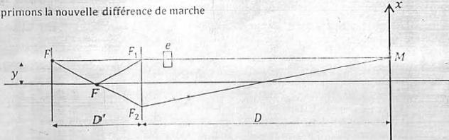
Soit  $t$  le temps nécessaire à la lumière pour traverser la lame d'épaisseur  $e$ . On a :  $t = \frac{e}{c'}$  avec  $c' = \frac{c}{n}$ . Pendant ce temps la lumière aurait parcouru dans l'air le trajet :  $e' = ct = \frac{ce}{c'} = ne$ . Le trajet  $F_1M$  à alors augmenté de  $e' - e = (n - 1)e$  d'où la nouvelle différence de marche :  $\delta = F_1M - F_1M = \frac{ax}{D} - (n - 1)e$
